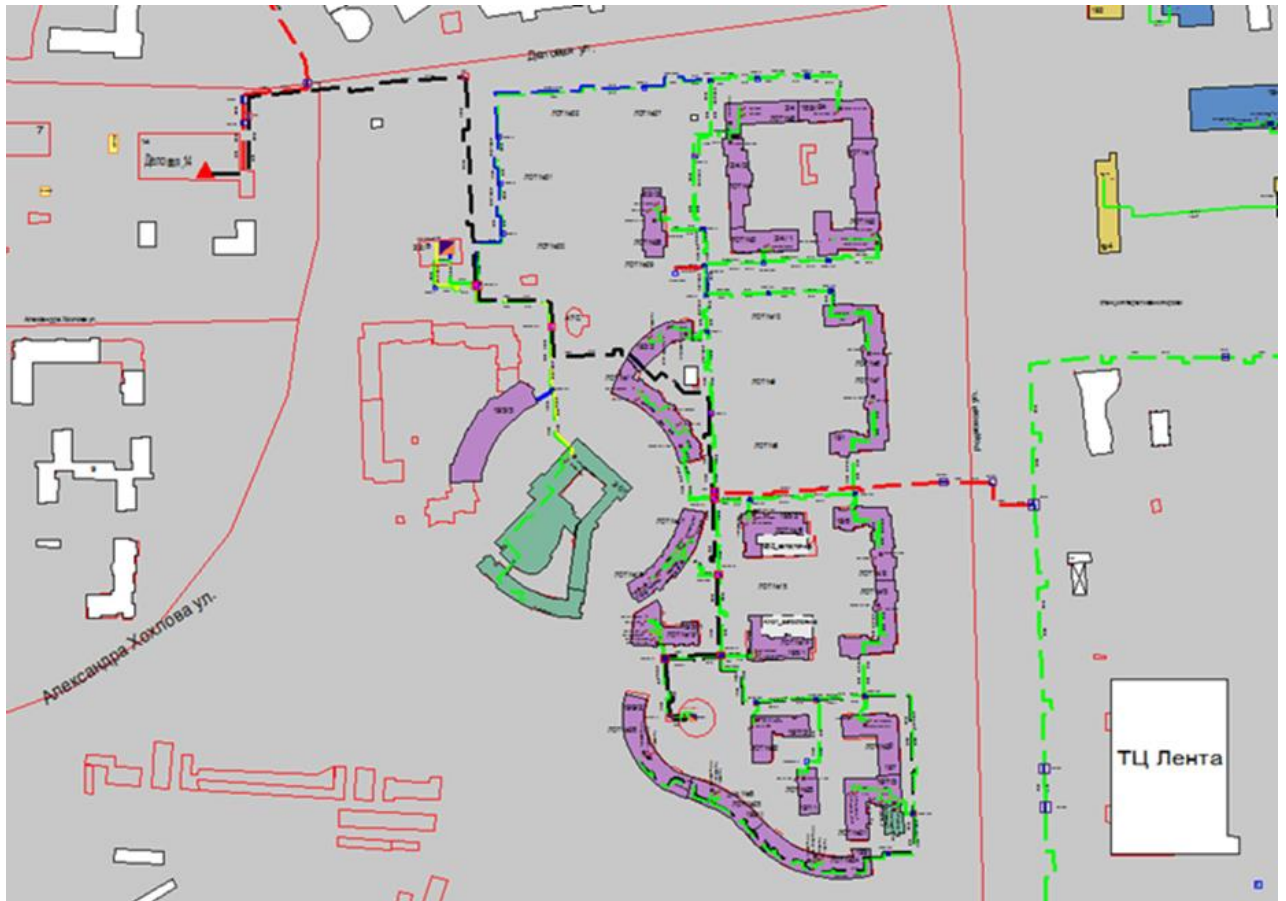
Рисунок 3.120 – Трассировка теплопровода от котельной ООО «Нижновтеплоэнерго» по ул. Деловая, д. 14 до конечного потребителя «ПТ-Рыбак,10/1»
