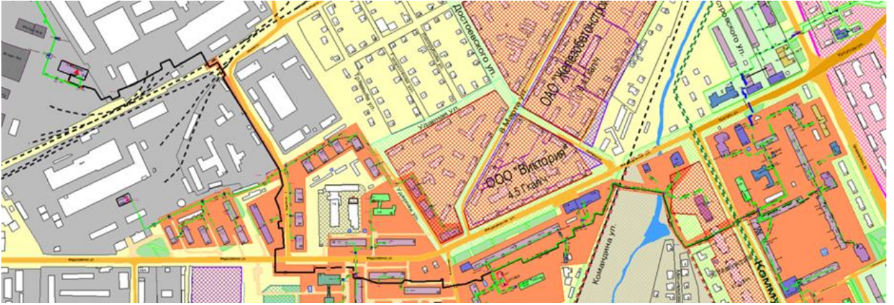
Рисунок 3...147 – Трассировка теплопровода от котельной ФГУП «Завод Электромаш» по ул. Федосеенко, д. 64 до конечного потребителя «ПТ-Остров,9»
