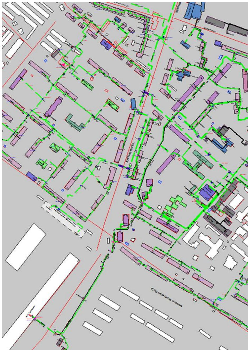
Рисунок 3...152 – Трассировка теплопровода от котельной ГП «ОКБМ им. И.И. Африкантова» по Бурнаковскому пр., д. 15 до конечного потребителя «ПТ-Куйбыш,32,30»
